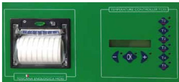
Il visualizzatore serve per visualizzare e regolare le temperature del prodotto durante tutto il processo di lavorazione. Generalmente vengono riportate le seguenti temperature, ma possono cambiare a seconda dell'impianto:
